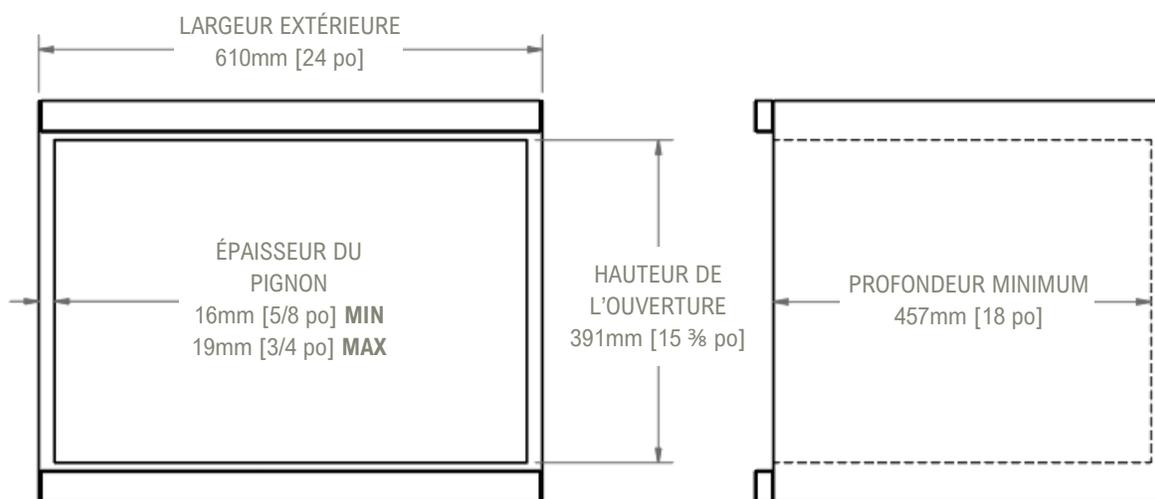
\*Pour une installation en saillie, l'ouverture doit être d'au moins 1/8 po plus petite que la largeur et la hauteur du cadre.
