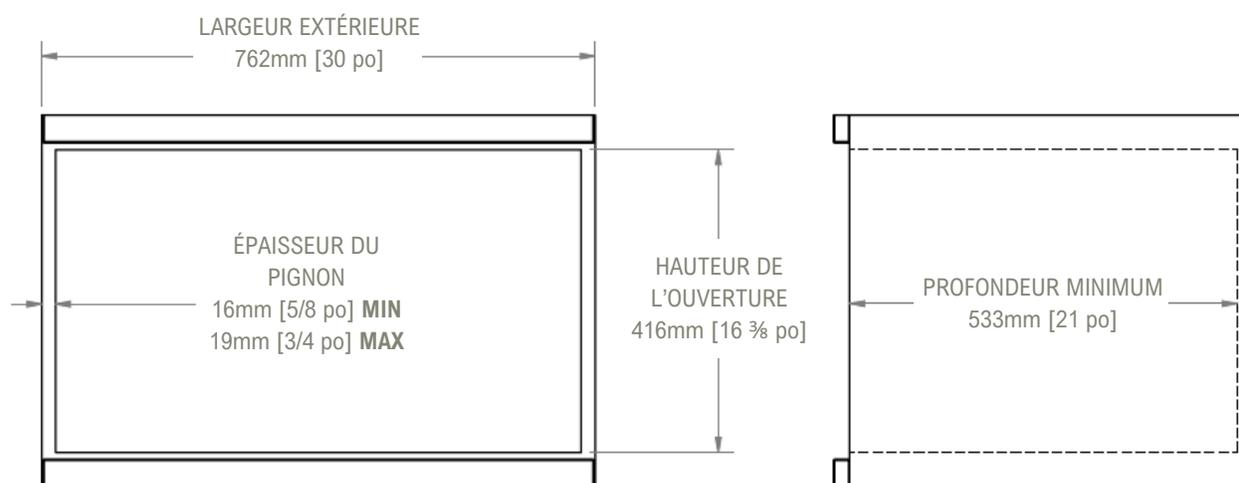
\*Pour une installation en saillie, l'ouverture doit être d'au moins 1/8 po plus petite que la largeur et la hauteur du cadre.
