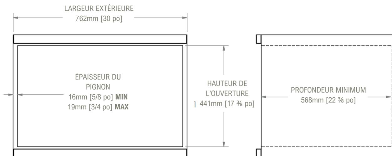
\*Pour une installation en saillie, l'ouverture doit être d'au moins 1/8 po plus petite que la largeur et la hauteur du cadre.
